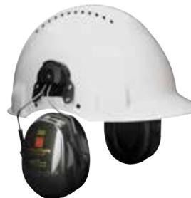
Противошумные наушники Peltor Optime II выпускаются с наголовными креплениями четырех видов: с обычным оголовьем, складным оголовьем, затылочной дугой и элементами крепления к каске. Наушники Optime II - средняя противошумная эффективность - 31 дБ. Данные наушники разработаны для защиты от интенсивных шумов и обеспечивают надежную защиту от шумов высокой, средней и низкой частот.
