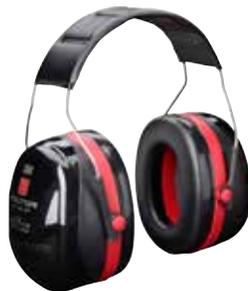
Противошумные наушники Optime III являются самыми эффективными противошумными наушниками в серии Optime. Они были специально разработаны для защиты слуха в условиях экстремально высокого уровня шума. Их эффективность основана на новой технологии двойного корпуса звукоизолирующих чашек, которая сводит к минимуму резонансный эффект, возникающий в области узлов крепления чашек на оголовье.
