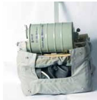
Комплектуется регенеративными патронами РП-7Б и одной маской МИА-1. Имеется переговорное устройство. Время защитного действия при нагрузке – не менее 45 минут. В состоянии покоя – 180 минут. Масса – 3,5 кг. Масса патрона – 1,8 кг. Гарантийный срок хранения регенеративного патрона – 5 лет.
